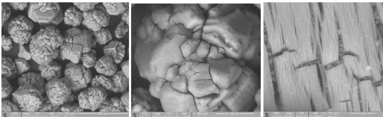
Рис. 1. СЭМ-микрофотографии глинозема Г-0
