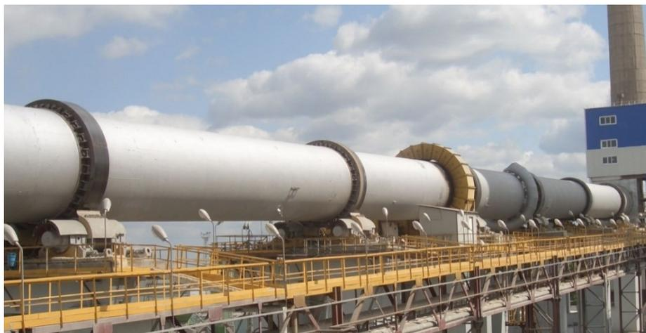
Рис. 1. Вращающаяся обжиговая печь для производства цементного клинкера
